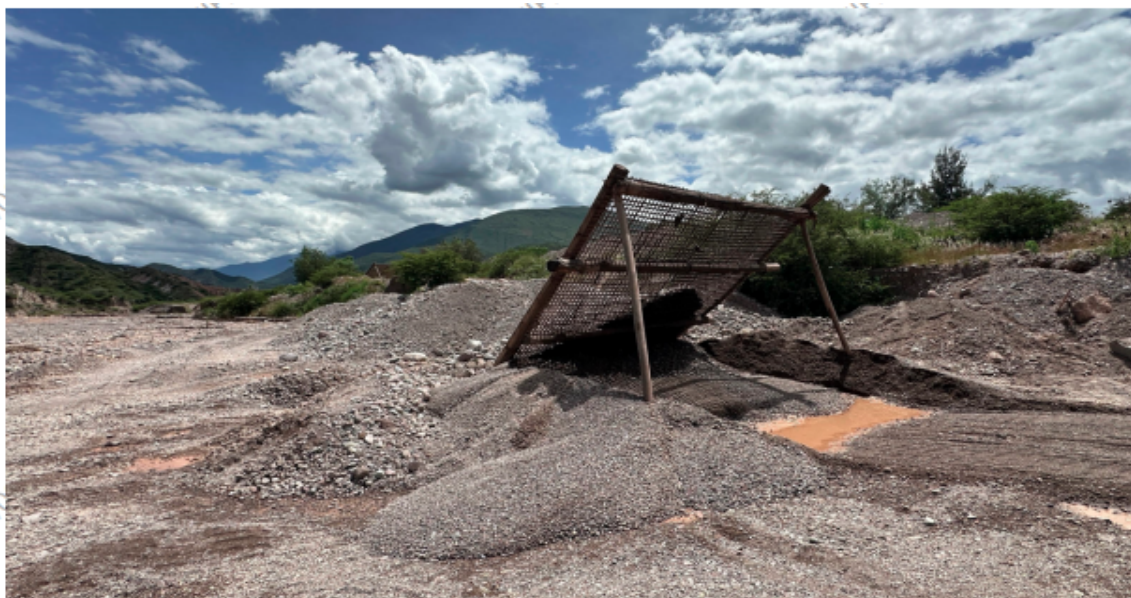
FOTO 02: AREA DE INTERVENCION EN LA QUE SE APRECIA LA ZARANDA OCUPANDO EL CAUCE DEL RÍO CHILICO
